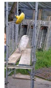
Allestimento della prova di carico dinamico
